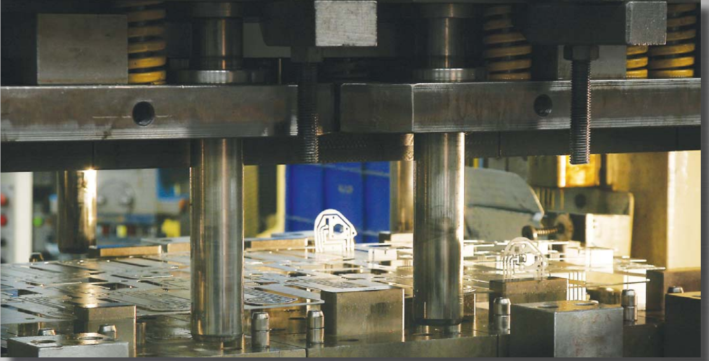
Prograsif kalıplara otomasyon uyarlaması Adaptation of automation to progressive moulds
