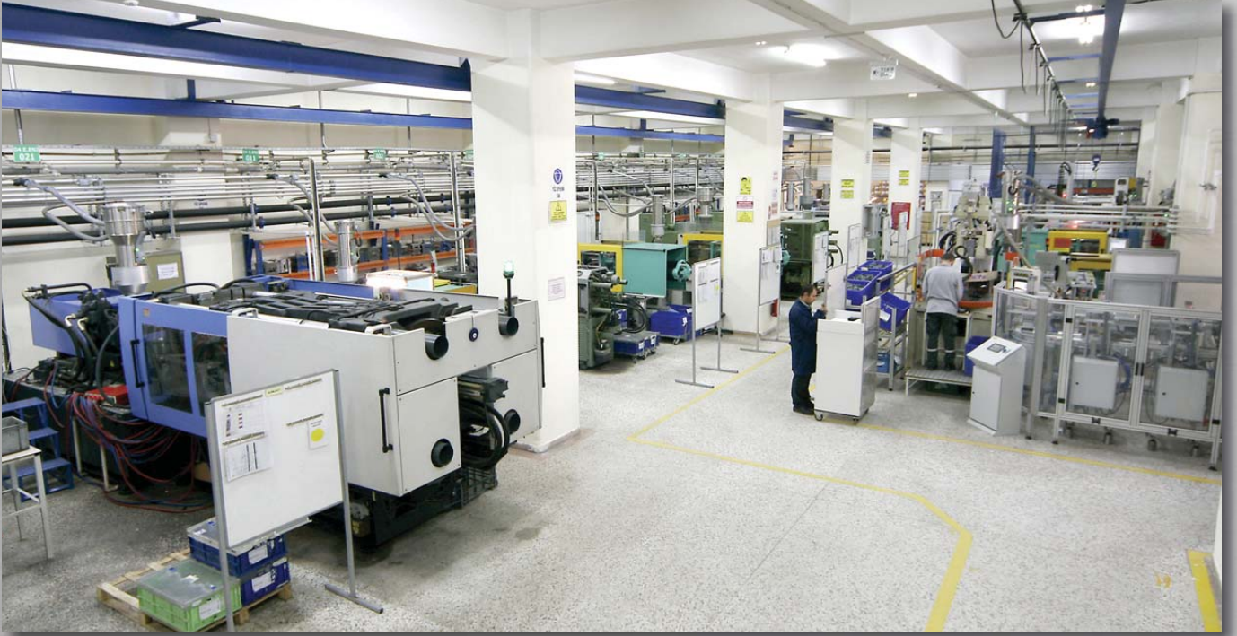
Plastik Enjeksiyon hatları ve Merkezi kurutma, besleme, ve dağıtım ünitesi ile kaliteli üretim Plastic Injection lines and Quality production with the centralised drying, feeding and conveying system
